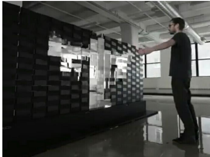
شكل رقم (18) يوضح فكرة عمل الحساس المتأثر بحركة الشخص المقابل للفاصل المعدنى
